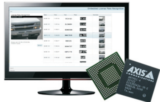
Mirame LPR embebido en cámara
